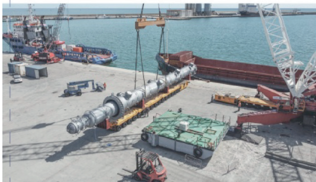
FASE DI CARICO SU NAVE DI UN REATTORE WALTER TOSTO
