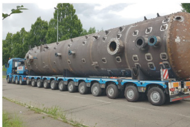
TRASPORTO ECCEZIONALE SU GOMMA DI UN APPARECCHIO IN PRESSIONE
